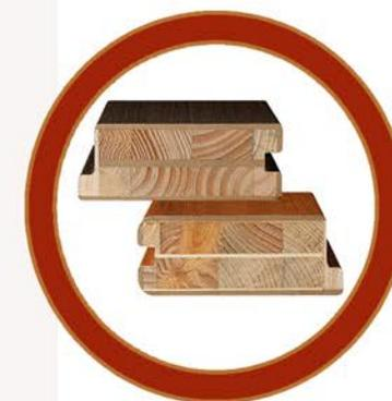
La Linea Pantografato è realizzata con una struttura alveolare che dona la giusta flessibilità al pannello porta successivamente placcato da entrambe i lati con pannelli da 8 mm. che ne consentono la lavorazione al pantografo. Questo tipo di fresatura garantisce l'indeformabilità del disegno nel tempo. I telai sono in listellare di pioppo ed i coprifili in multistrato di pioppo.
